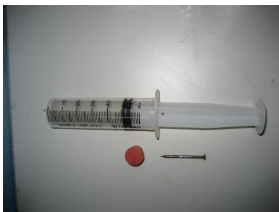
圖一 本實驗裝置(注射筒、鐵釘、3 號活塞)
